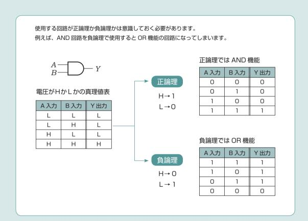
一般的なデータ回路などは正論理で設計されることが多く、割り込み制御用信号線などでは負論理回路で設計されることが多くなっています。
