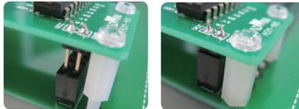
電源供給ピン：IC ボードを抜き差しする際は、このピンを曲げないようにご注意ください。
