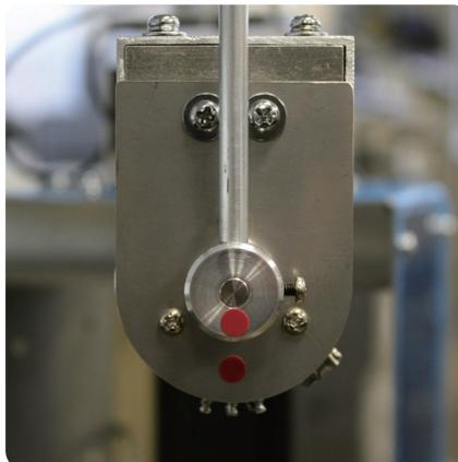
振れ止め制御でも倒立制御でも「制御状態で**赤丸マークが下**になる向きに振子を取り付ける」と覚えておくといいでしょう。
