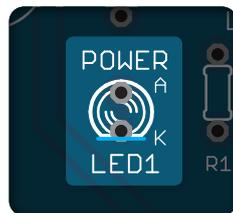
パッケージの平らな面と基板の印刷を合わせる。
