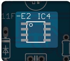
パッケージの切り欠きマークと基板の印刷を合わせる。
