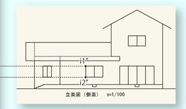
立面図(側面)の窓の点 i1"、i2" に対応する点を立面図(正面)に i1'、i2' としてを描き込みます。
