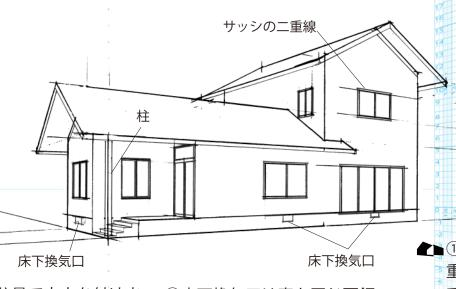
②柱は目分量で太さを付けます。すでに描かれている線に 平行におよそ 1mm 程度の幅 で左右に線を描きます。 ③床下換気口は窓と同じ要領で描きます。床下換気口は小さいので、おおよその位置と大きさを立面図で確認し、目分量で描きます。
