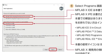
MPLAB X IDE は本書で使用するので必須です。 MPLAB X IPE は書き込み専用ソフトです。 本書での解説はありません。以下の対応ライター をお持ちでない方はインストール不要です。 • MPLAB ICD 3 In-Circuit Debugger MPLAB PICkit ™ 3 Debugger/Programmer
